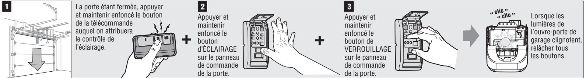
Pour procéder à un essai, appuyer sur le bouton de la télécommande. Les lumières de l'ouvre-porte de garage doivent s'allumer ou s'éteindre mais la porte ne doit pas se déplacer.
